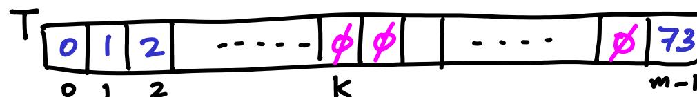
$\text{search}(T, 2) = 2$     //  $\text{insert}(T, k) \rightarrow T[k] = k$     //  $\text{delete}(T, k) \rightarrow T[k] = \phi$
