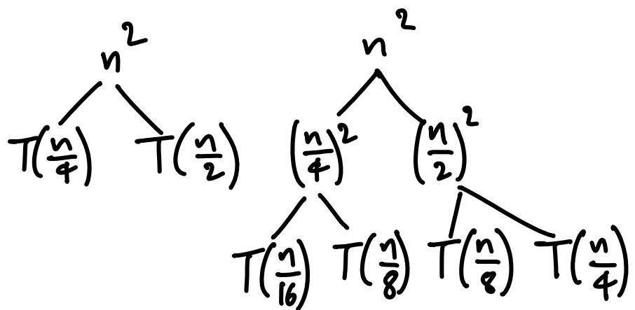
$$n^2 \cdot \left[ 1 + \frac{5}{16} + \left(\frac{5}{16}\right)^2 + \dots + \left(\frac{5}{16}\right)^k + \dots \right]$$
